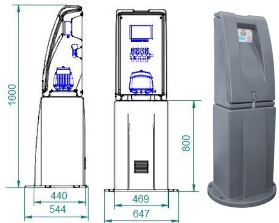
Dimensions armoire de commande (mm)
